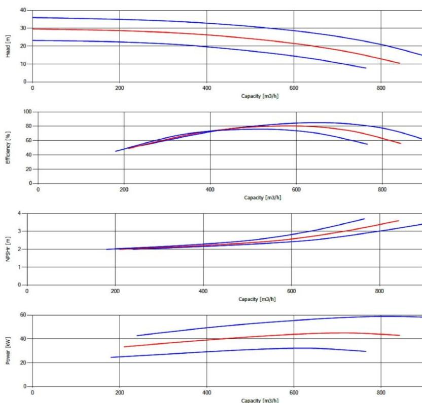
\* مقادیر ارتفاع و توان برای دانسیته  $r=1 \text{ kg/dm}^3$  و گرانروی سینماتیک  $20\text{mm}/\text{s}$  می باشد.
